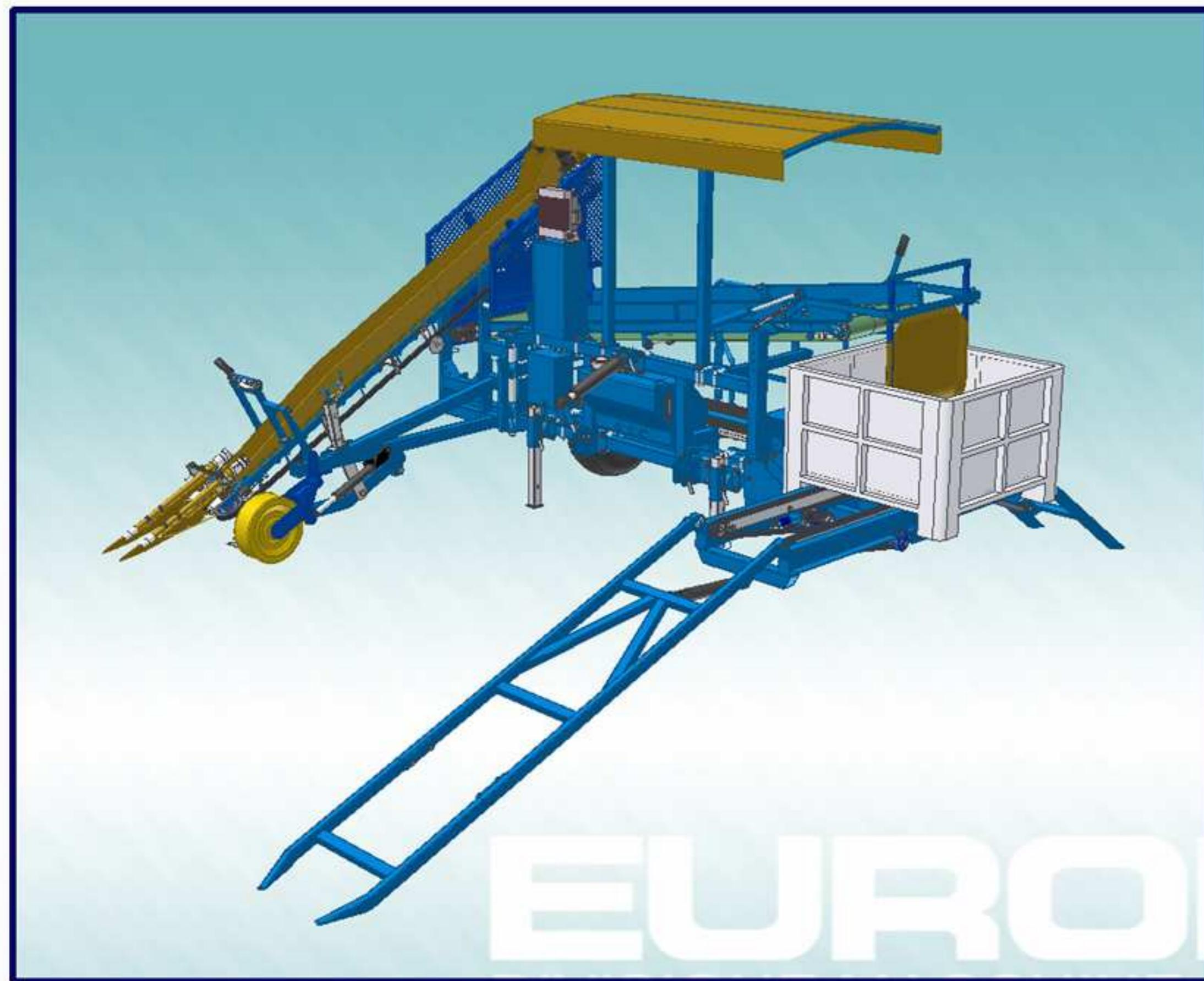
**F 285 - P** Dans cette variante, la récolteuse est équipée d'une plate-forme permettant de décharger le produit dans des bacs. La plate-forme peut porter un maximum de 5 bacs qui sont chargés et déchargés après avoir été remplis, au moyen de simples commandes hydrauliques, sans devoir interrompre l'opération de récolte de fenouil. Au cours des déplacements de la machine, une commande hydraulique permet de replier la plate-forme sous le tapis de tri, afin de réduire l'encombrement.
