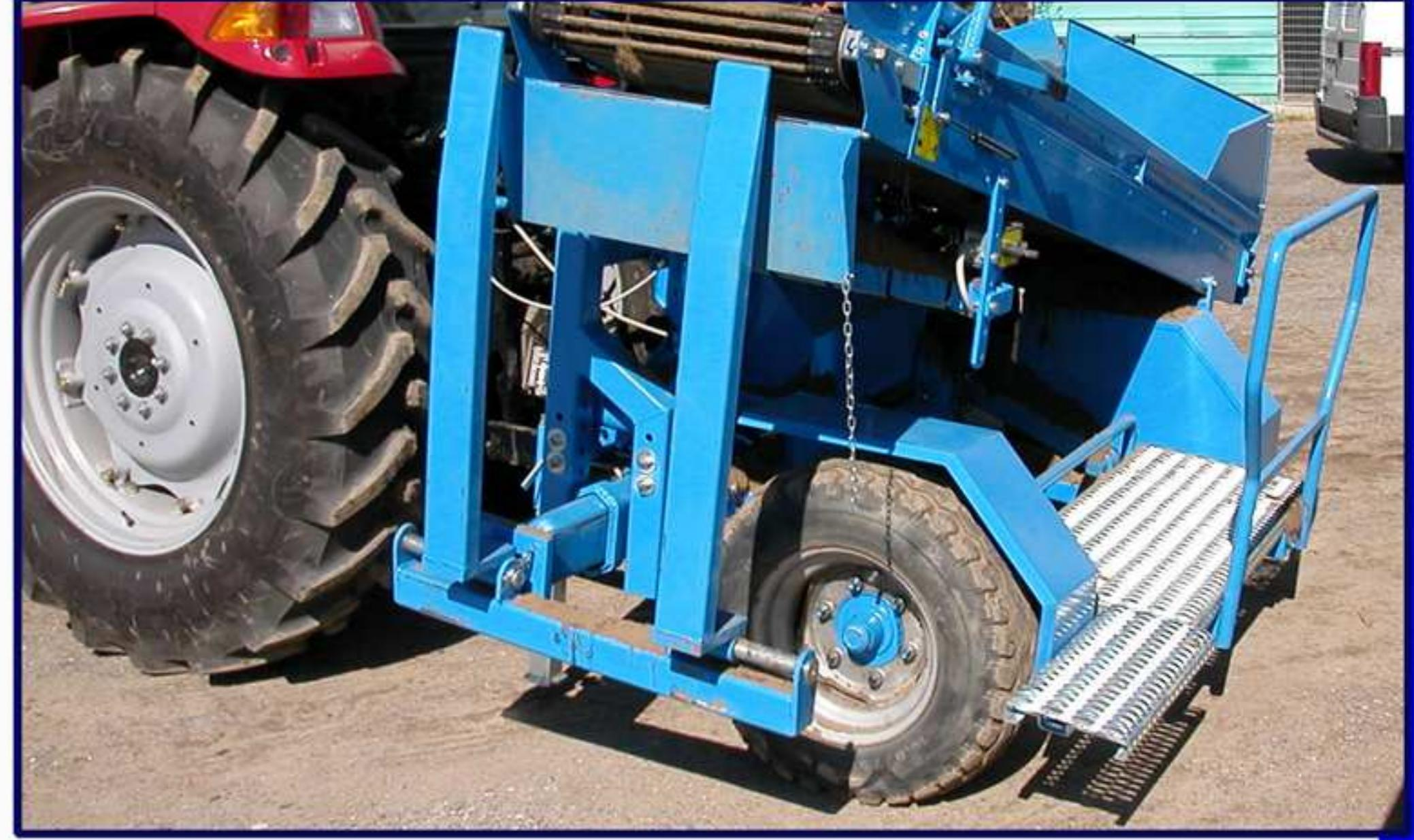
**F 285 - F** La fourche télescopique latérale permet d'enlever les bacs du rayon d'action de la récolteuse, ce qui évite de devoir les déplacer avant de procéder à la récolte de la rangée suivante. Entièrement gérée par des commandes hydrauliques, la récolteuse peut être équipée d'une fourche longitudinale pouvant transporter 3 bacs vides. La fourche latérale peut être repliée afin de ne pas dépasser du gabarit de la machine.
