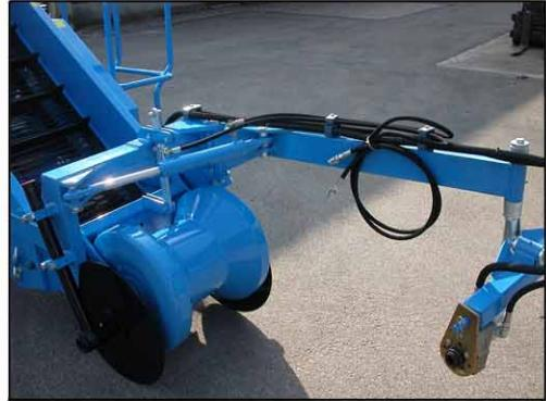
Timon reglable hidraulicamente
