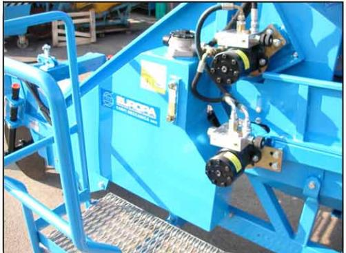
Moteurs hydrauliques, vannes de regulation
