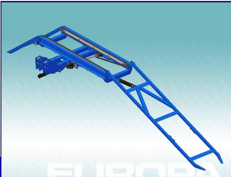
**CS 460-P** En esta versión la cosechadora está equipada con una plataforma que permite descargar el producto dentro de los contenedores. La plataforma carga hasta 5 contenedores. Los contenedores se cargan y descargan, una vez llenos, con simples mandos hidráulicos, sin tener que interrumpir la cosecha de las zanahorias. Durante las trasferecias, la plataforma se puede replegar debajo de la cinta de selección, a través de un mando hidráulico, para reducir la envergadura de la máquina.
