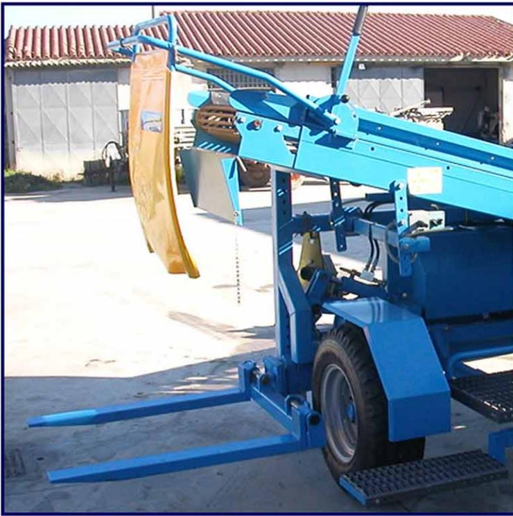
**CS 460-F** La fourche télescopique latérale permet d'enlever les bacs du rayon d'action de la récolteuse, ce qui évite de devoir les déplacer avant de procéder à la récolte de la rangée suivante. Entièrement gérée par des commandes hydrauliques, la récolteuse peut être équipée d'une fourche longitudinale pouvant transporter 3 bacs vides. La fourche latérale peut être repliée afin de ne pas dépasser du gabarit de la machine.
