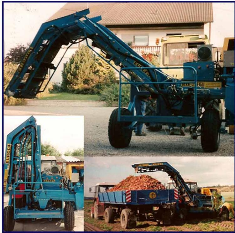
**CS 460-N** Le tapis de cette variante décharge le produit directement dans la benne d'une remorque ou d'un camion. Une fois replié, le tapis ne dépasse pas du gabarit de la récolteuse.
